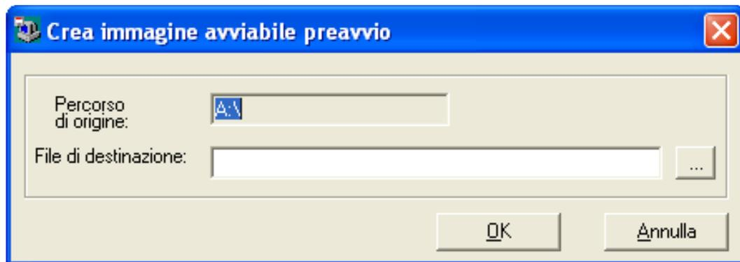
**Percorso di origine:** origine delle informazioni da usare per la creazione di un'immagine di un file PBI. Generalmente si tratta del disco floppy avviabile creato tramite la scheda *Avvio da CD* della finestra di dialogo.
